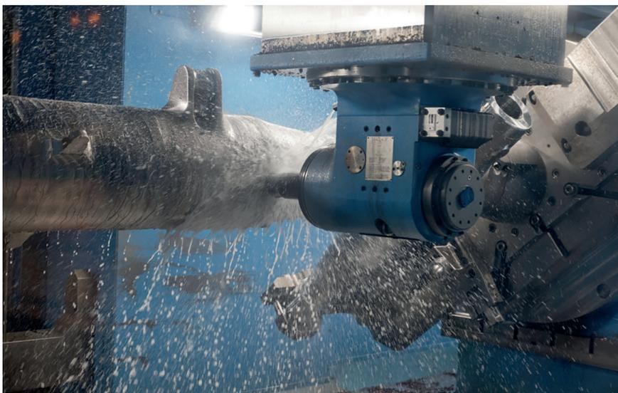
3 Die Hauptkomponente jedes Fahrwerksystems ist ein massives Schmiedestück, das bis zu acht Tonnen wiegen kann. Trotz Kühlmittel im Arbeitsraum liefert das Rauheitsmessgerät TC63-RG zuverlässige Ergebnisse © Blum-Novotest
